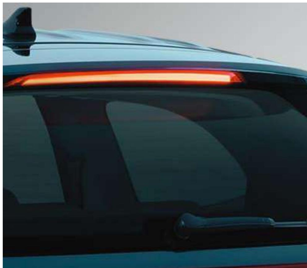
Задний спойлер с дополнительным стоп-сигналом
