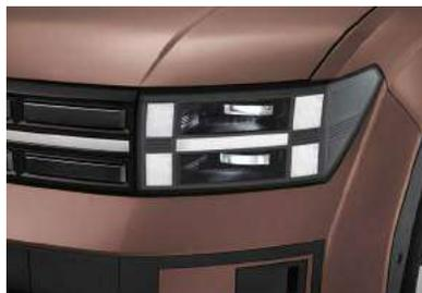
Полностью светодиодные фары (проекторного типа)
