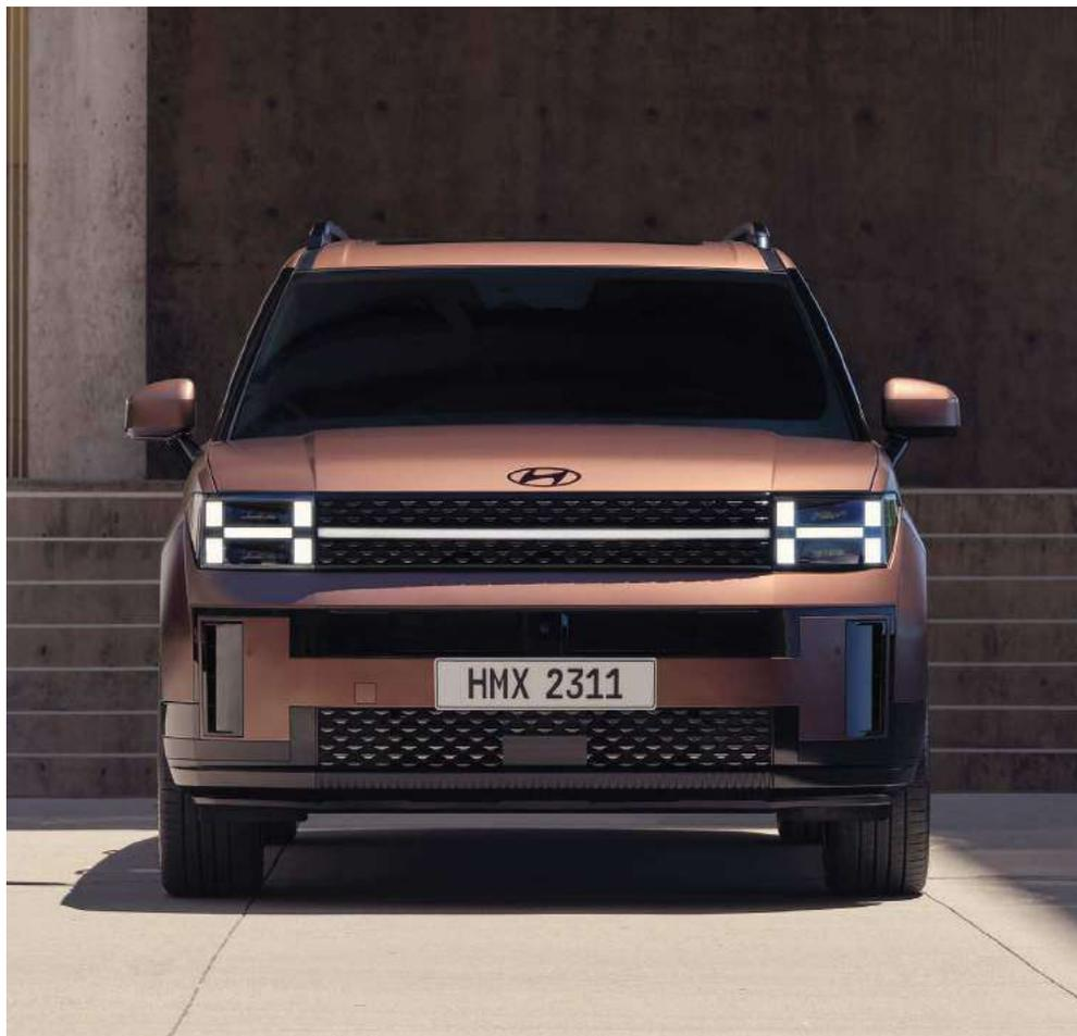
H-образные фары головного света (светодиодные, проекционного типа)
