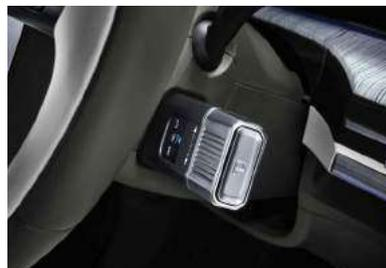
Рычаг селектора передач на рулевой колонке (SBW)
